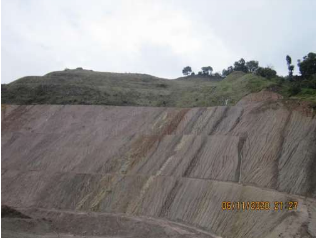
Se aprecia uno de los frentes de explotación de la ladrillera activa con instrumento ambiental, en proceso de reconfiguración morfológica y revegetalización de los taludes superiores.
