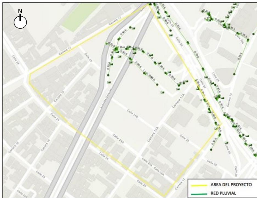
Ilustración 4.2.6-4.Red local de alcantarillado pluvial
