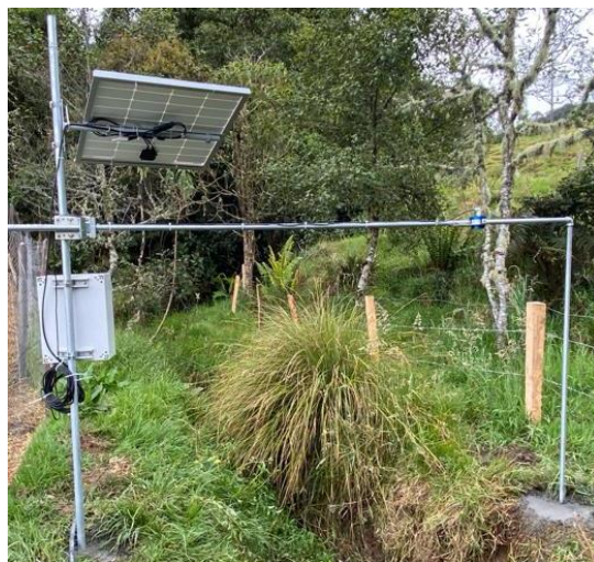
Figura 12. Sensor de nivel instalado en el colegio Jaime Garzón – Sede Las Auras.
