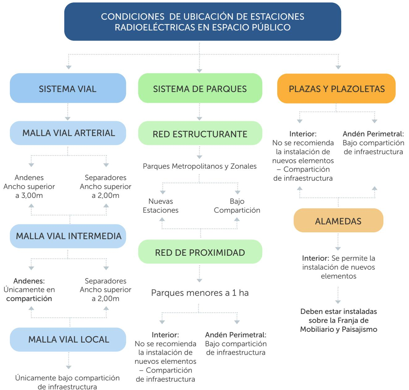
Figura 1.27. Localización e instalación de nuevas estaciones radioeléctricas en el espacio público
