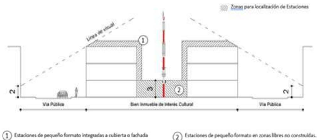
La altura total de la estación, incluido el pararrayos, se determina por medio de una relación de semejanza en triángulo y se calcula por medio de la siguiente fórmula:
