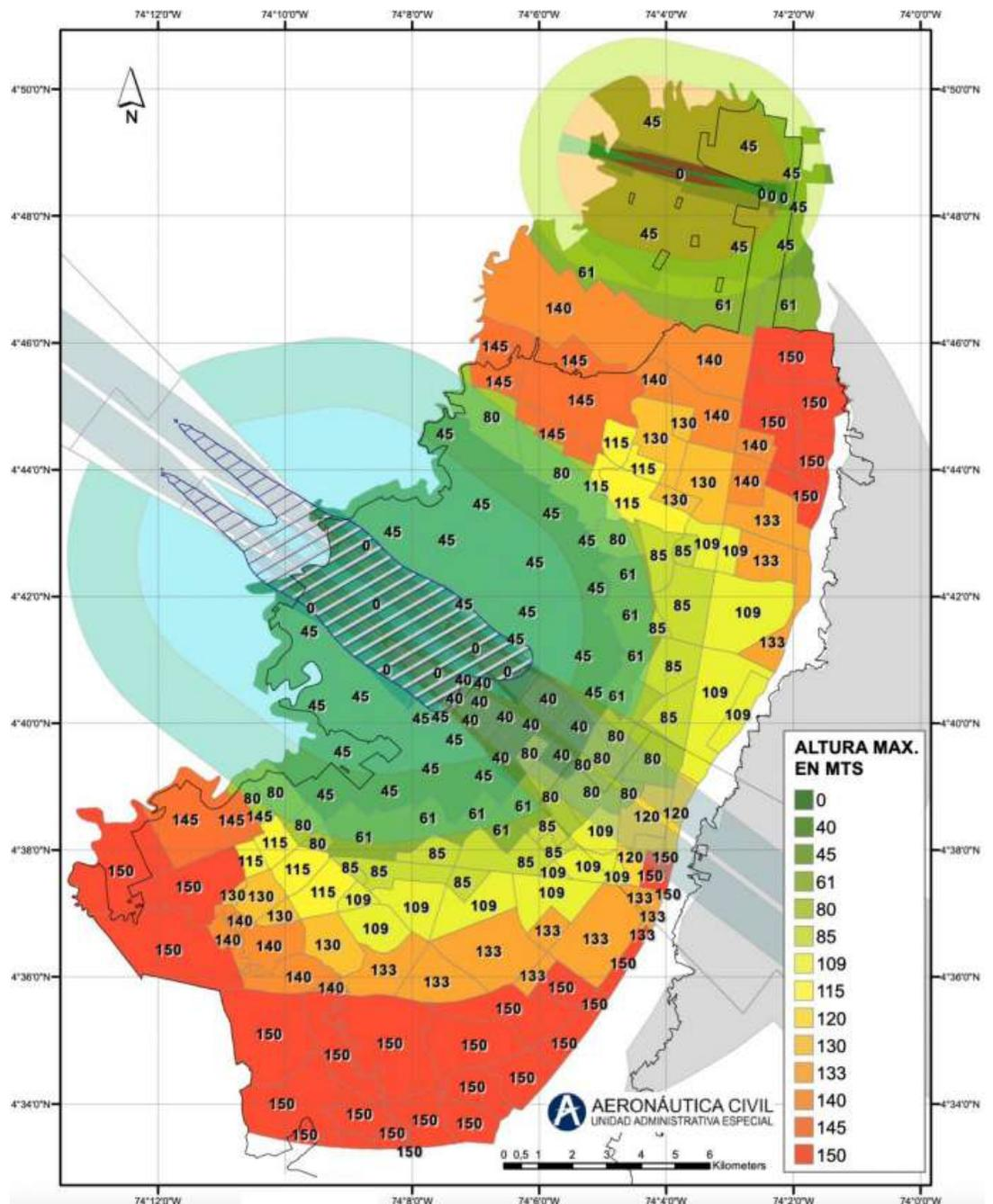
Figura 1.2. Sectorización de obstáculos por altura del espacio aéreo de Bogotá. Aeropuerto Internacional El Dorado y Aeropuerto Guaymaral
