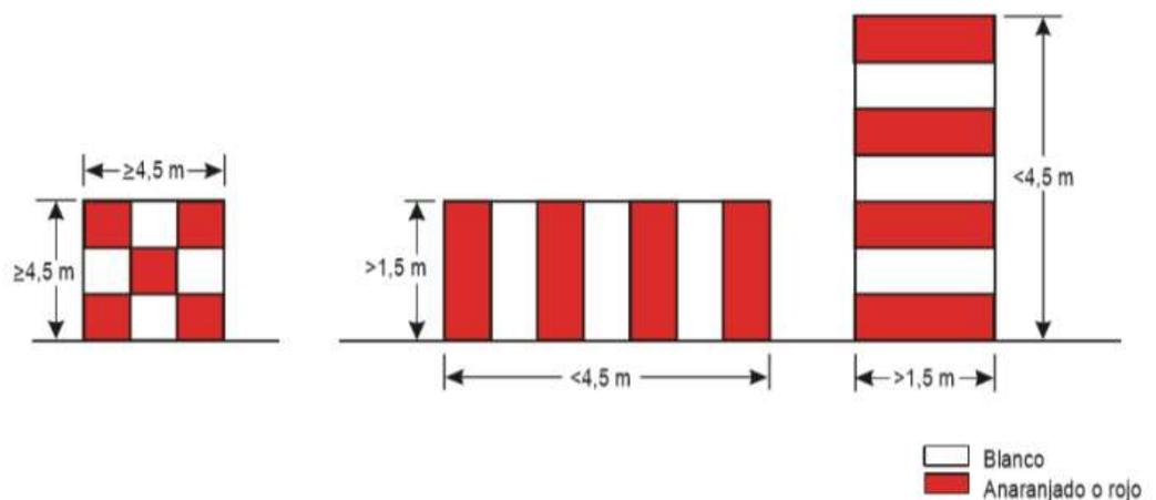
Figura 1.4. Configuración básica para la señalización de objetos (figura 6.1. RAC 14 Enmienda 19, abril de 2024)
