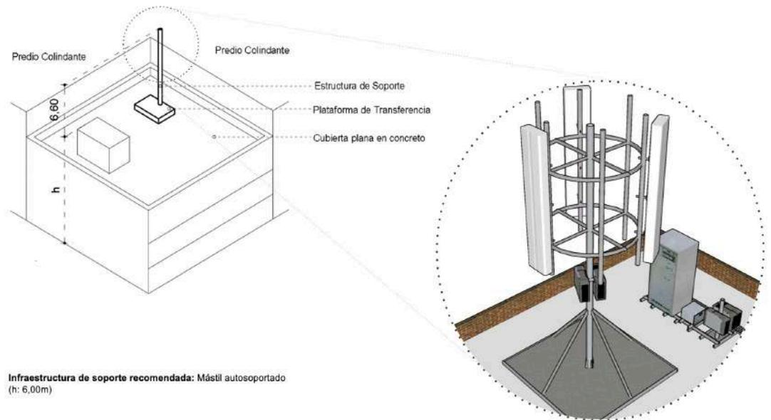
Figura 1.19. Componentes de una estación radioeléctrica sobre cubierta
