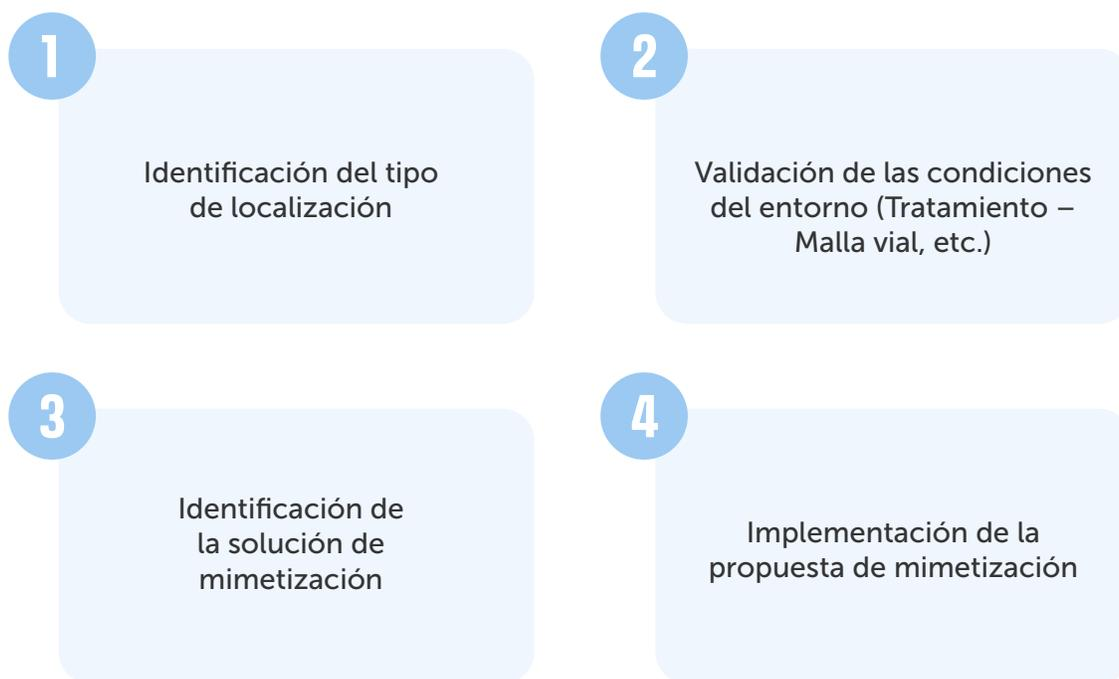
Figura 1.39. Procedimiento recomendado para la mimetización y camuflaje de una estación radioeléctrica
