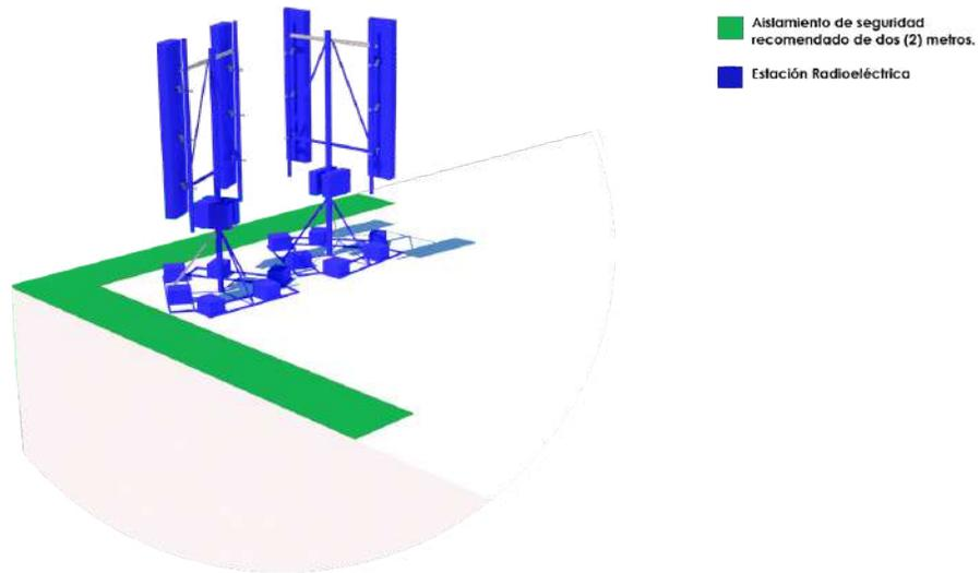
Figura 1.21. Distancia de seguridad, estaciones radioeléctricas sobre cubierta
