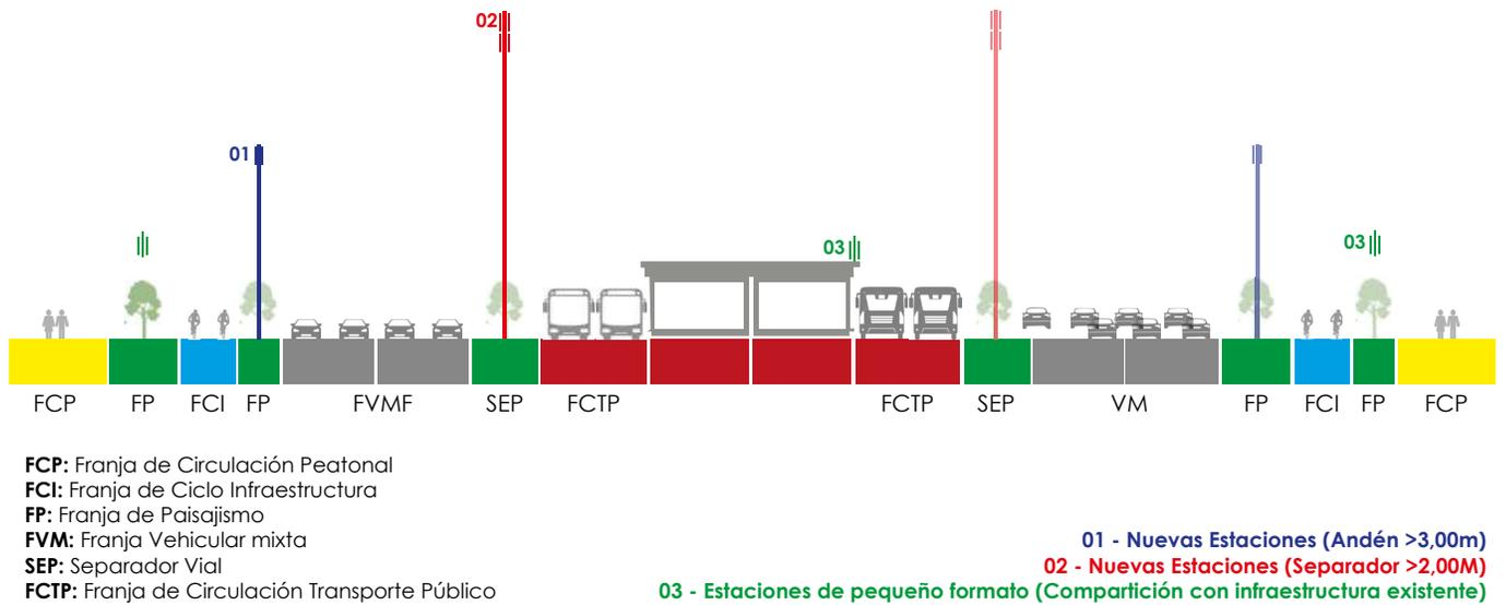
Figura 1.28. Ejemplificación de localización de estaciones radioeléctricas sobre malla vial arterial A-0 (urbana)
