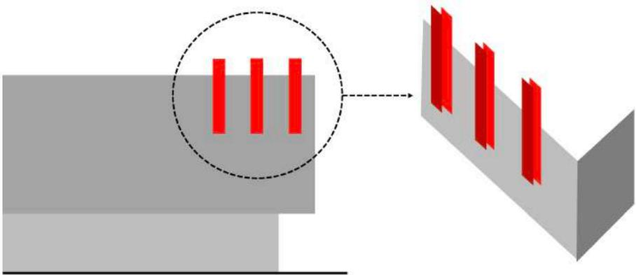
Figura 1.13. Estaciones radioeléctricas de pequeño formato sobre fachadas
