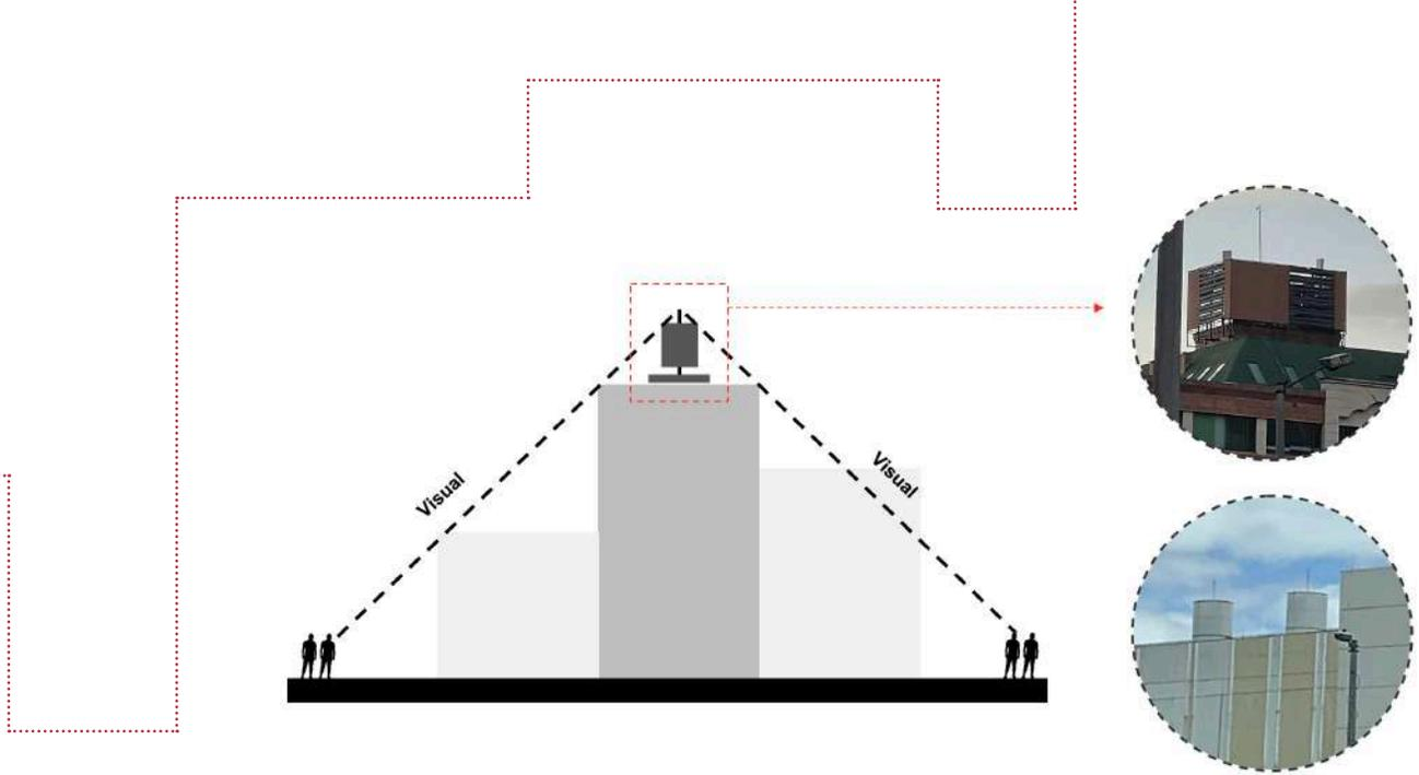
Figura 1.20. Localización y mimetización de elementos sobre cubierta
