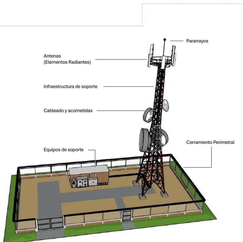
Figura 1.1. Elementos que conforman una estación radioeléctrica
