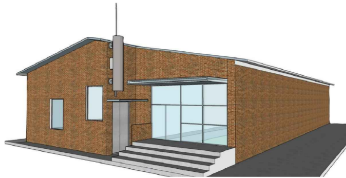
AXONOMETRIA UBICACIÓN SOPORTE DE ANTENAS MIMETIZADAS
