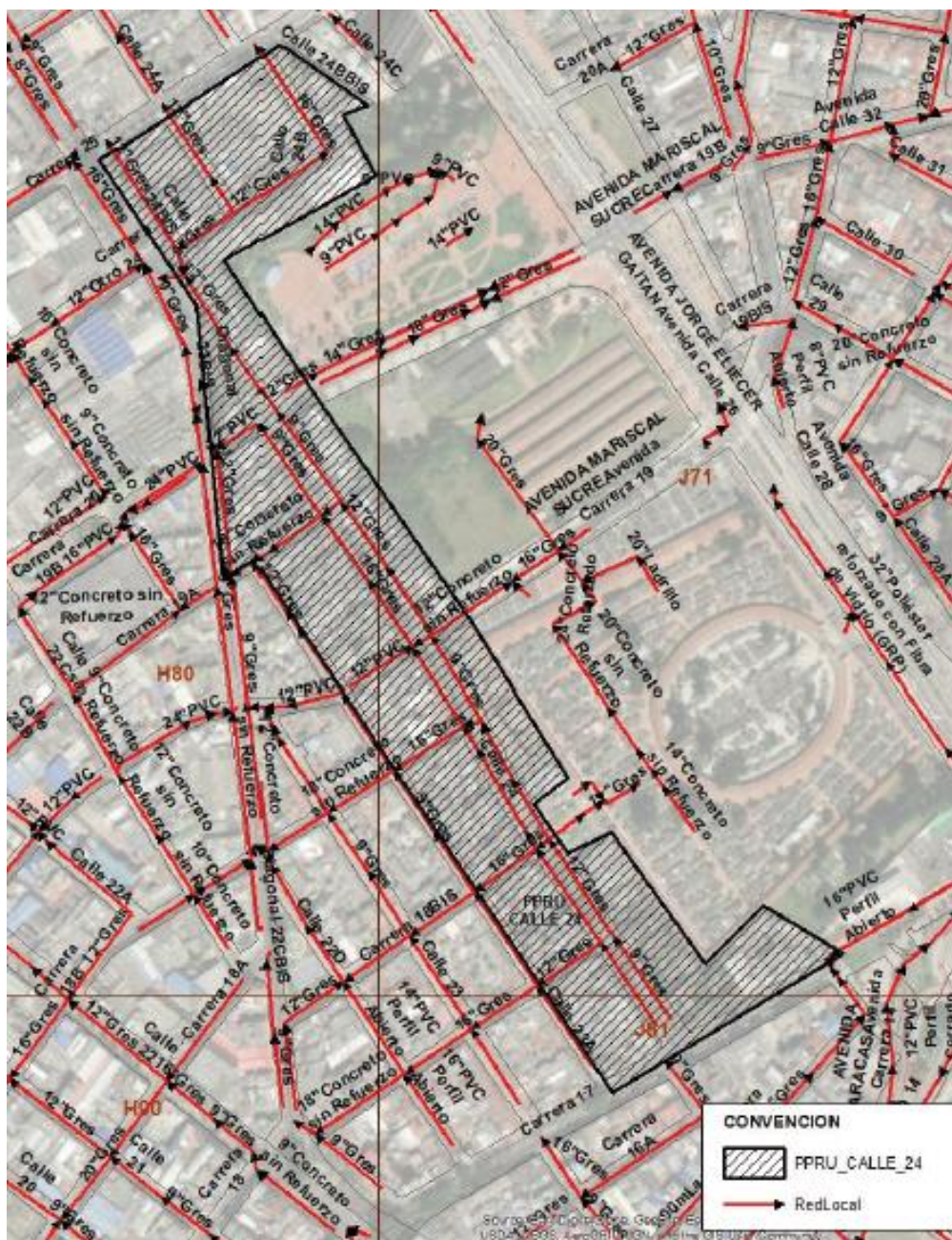
Figura 6. Redes locales alcantarillado combinado existente
