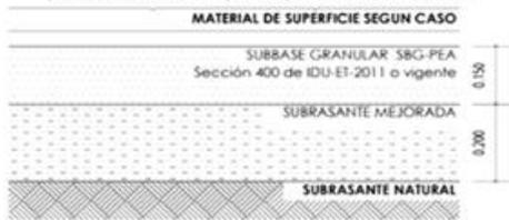
Estructuras para acceso vehicular, pompeyanos y vías con tránsito restringido para Subrasante - Tipo S2 y Criterio de diseño 3
