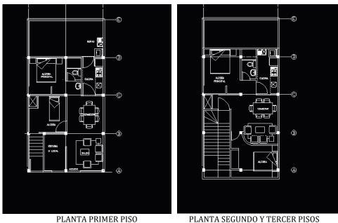
Diseño básico trifamiliar tipo V.I.P. por autoconstrucción, modelado apartir de diseños reales existentes en Bogotá.
