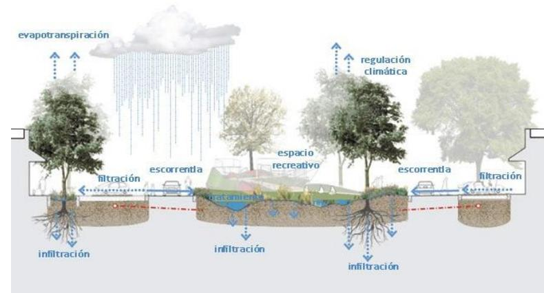
Imagen 08. Esquema de funcionamiento de los Sistemas Urbanos de Drenaje Sostenible.
