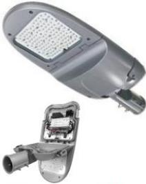
Luminaria LED para iluminación vial y exterior, con diseño moderno y robusto de un cuerpo en aluminio inyectado y compartimentos independientes para el conjunto óptico y eléctrico. Montaje en tubo de soporte para poste horizontal o en punta. Proyección uniforme de la luz, reduce los costos de consumo de energía y de mantenimiento.
