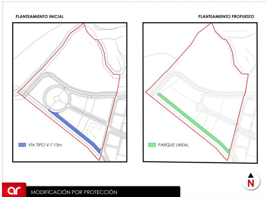
Adicionalmente, como se mostró en la reseña del estudio de movilidad, la nueva propuesta incluye la reducción del tamaño de la glorieta y una propuesta vial que soluciona la intersección entre la Diagonal 77B con la Transversal 129, dándole continuidad a la vía en doble calzada con un perfil de 25 metros y rematando en una glorieta central, diseñada con radio de 25 metros y calzada en un solo sentido de 9 metros.
