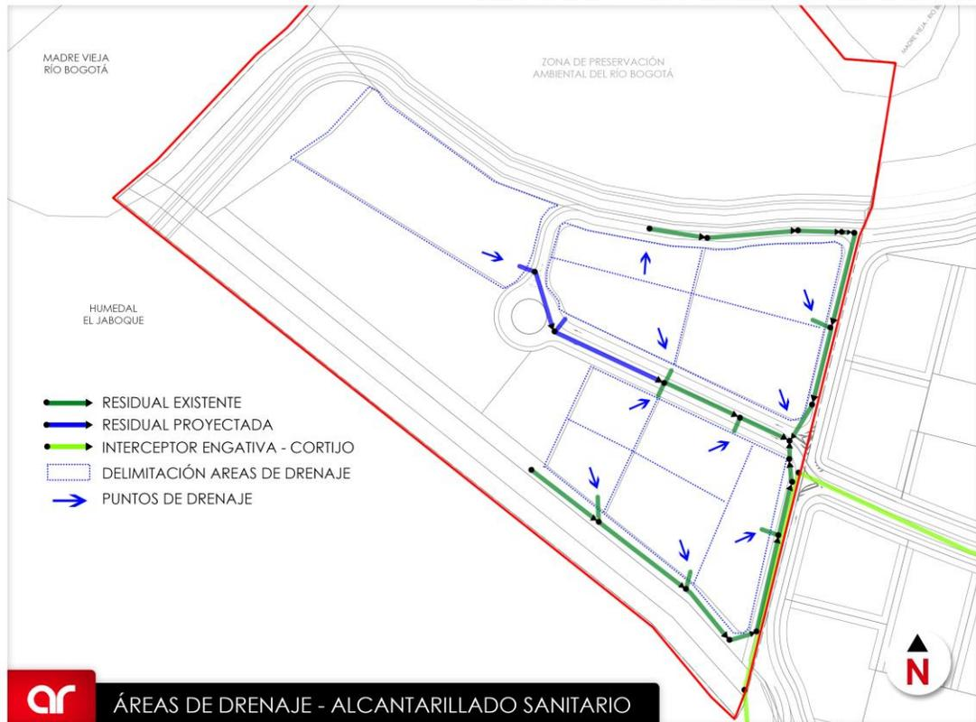
Para la determinación del caudal de diseño sanitario la norma de la EAAB NS-085 se remite al uso de la figura 1 presente en dicha norma, en la que se hallan los caudales unitarios de acuerdo al área y a la densidad. El área se determina con el área de drenaje tributaria acumulada, incluyendo el área propia del tramo. La densidad se determina bajo los siguientes rangos:
