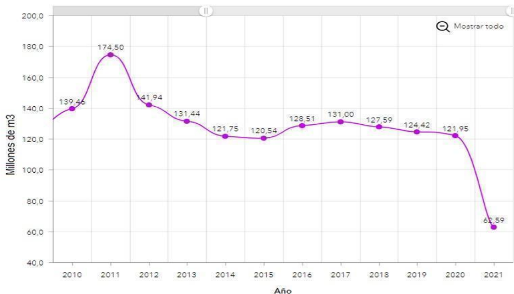
Ilustración 3 Caudal Medio de Agua Residual Tratada en PTAR Salitre
