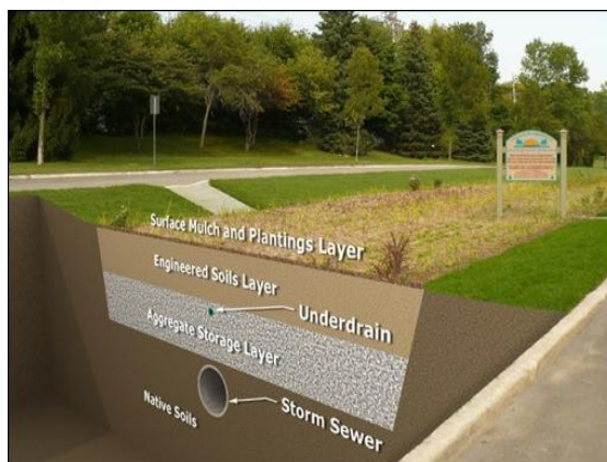
Imagen 12 Dren filtrante con capas granulares Fuente: lineamientos del componente paisajístico EAAB
