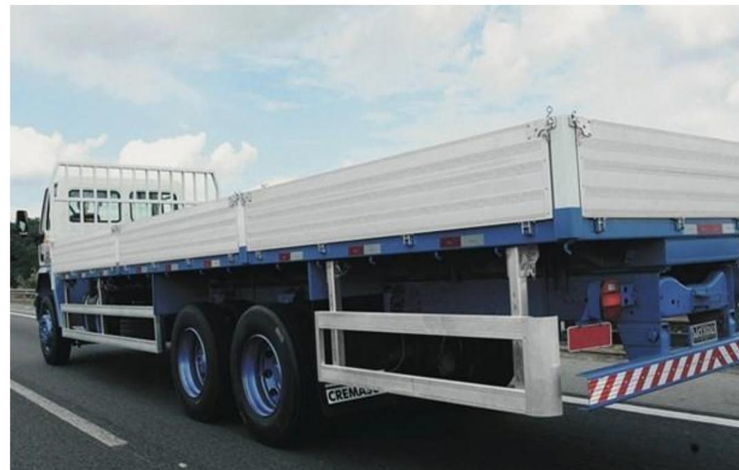
Imagen 2. Caracterización de principales espejos retrovisores complementarios para la minimización de puntos ciegos en vehículos de carga, Cemex, 2022, y Barreras antiempotramiento laterales y posteriores en vehículos de carga, extraído de la web: <https://www.ancosev.org/proteccion-lateral-en-vehiculos-pesados/>, 2022.
