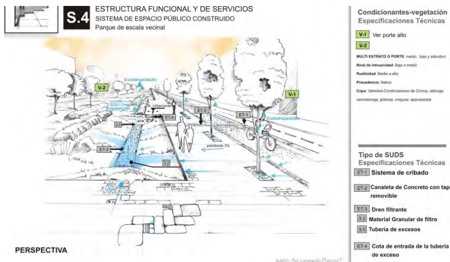
Ilustración 142 Estructura SUDS en parque lineal No. 2 - Vallado Primario (Cuneta Verde)
