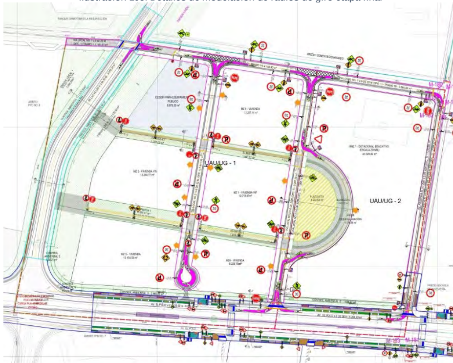
Ilustración 198. Detalles de modelación de radios de giro etapa final
