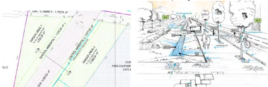
Ilustración 129 Detalle de trazado de la cuneta verde (Cartografía PPD Alameda)
