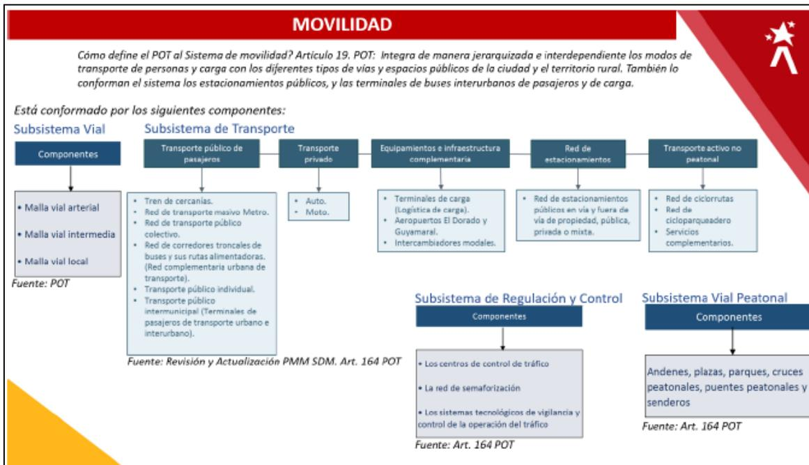
ILUSTRACIÓN 11. COMPONENTES DEL SISTEMA DE MOVILIDAD
