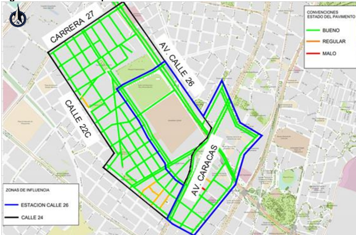
Figura 4-15. Estado del pavimento en el área de influencia
