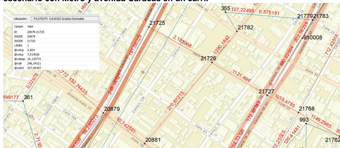
Figura 6-31. Resultado de volúmenes vehiculares, de acuerdo a modelo EMME, escenario con Metro y avenida Caracas en un carril
