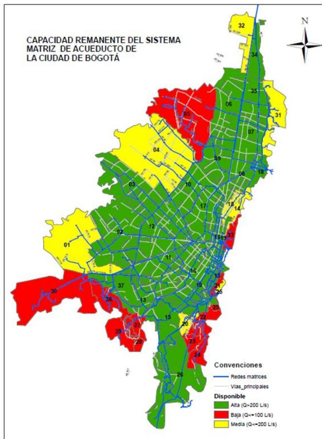
ILUSTRACIÓN 67 - CAPACIDAD REMANENTE DEL SISTEMA MATRIZ DE ACUEDUCTO DE LA CIUDAD DE BOGOTÁ. FUENTE PMMA EAB ESP 2016-2025.
