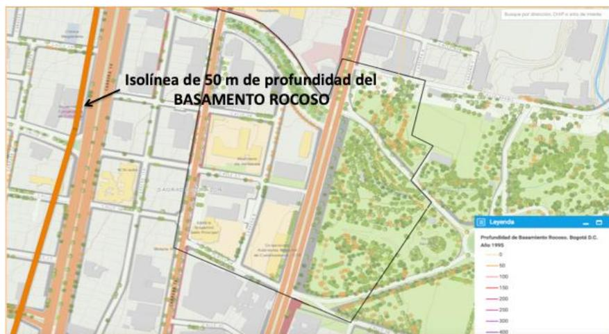
Imagen 14. Profundidad del basamento más cercana al PPRUCCE. Fuente: Zonificación de la respuesta sísmica de Bogotá para el diseño sismo resistente de edificaciones. FOPAE, 2010. Para la zona geotécnica de piedemonte B, se tienen las siguientes características de respuesta sísmica:
