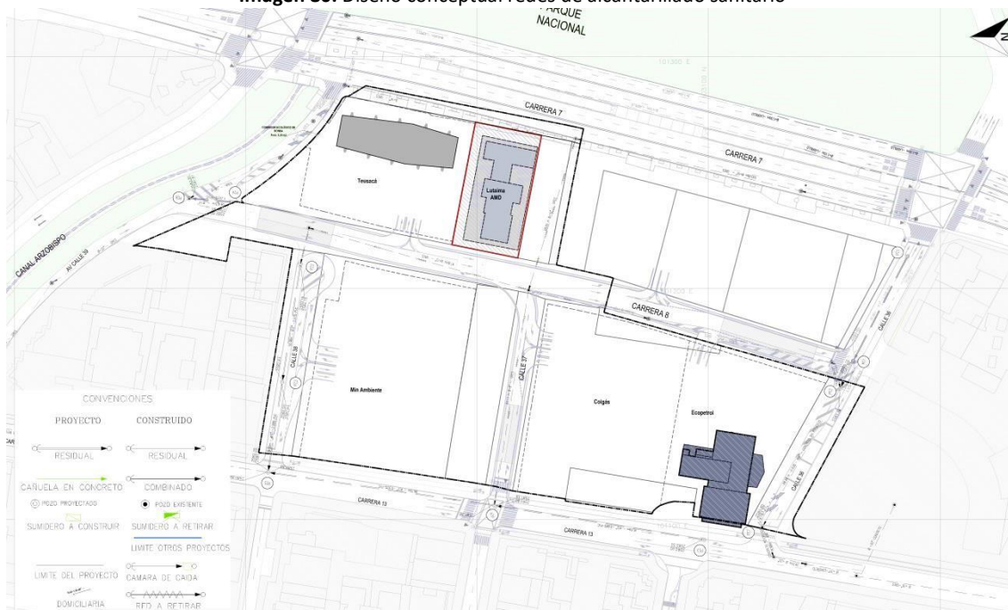
Imagen 80. Diseño conceptual redes de alcantarillado sanitario
