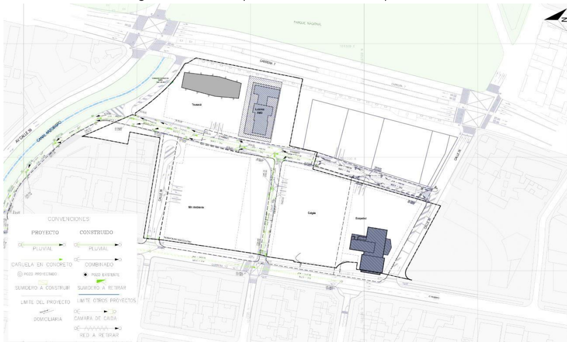
Imagen 81. Diseño conceptual redes de alcantarillado pluvial Nivel 0.
