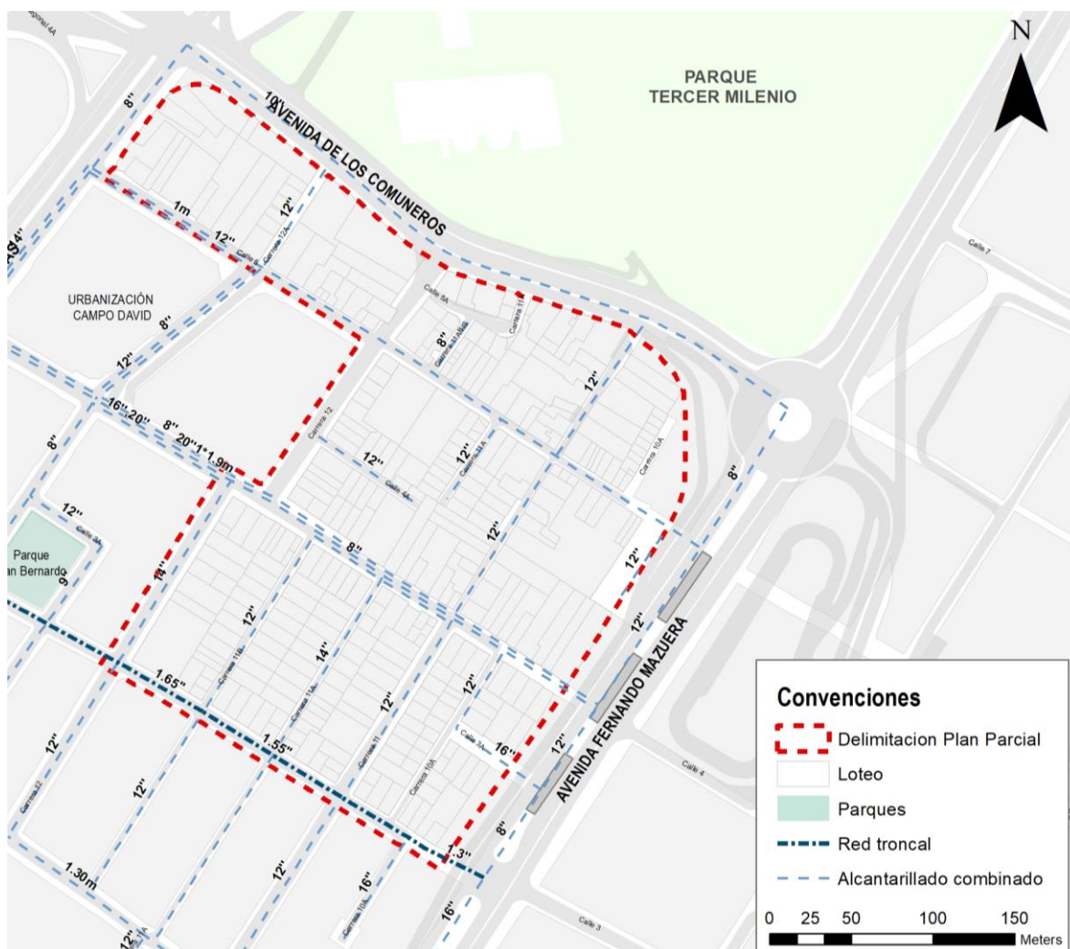
Plano 15. Redes de Alcantarillado
