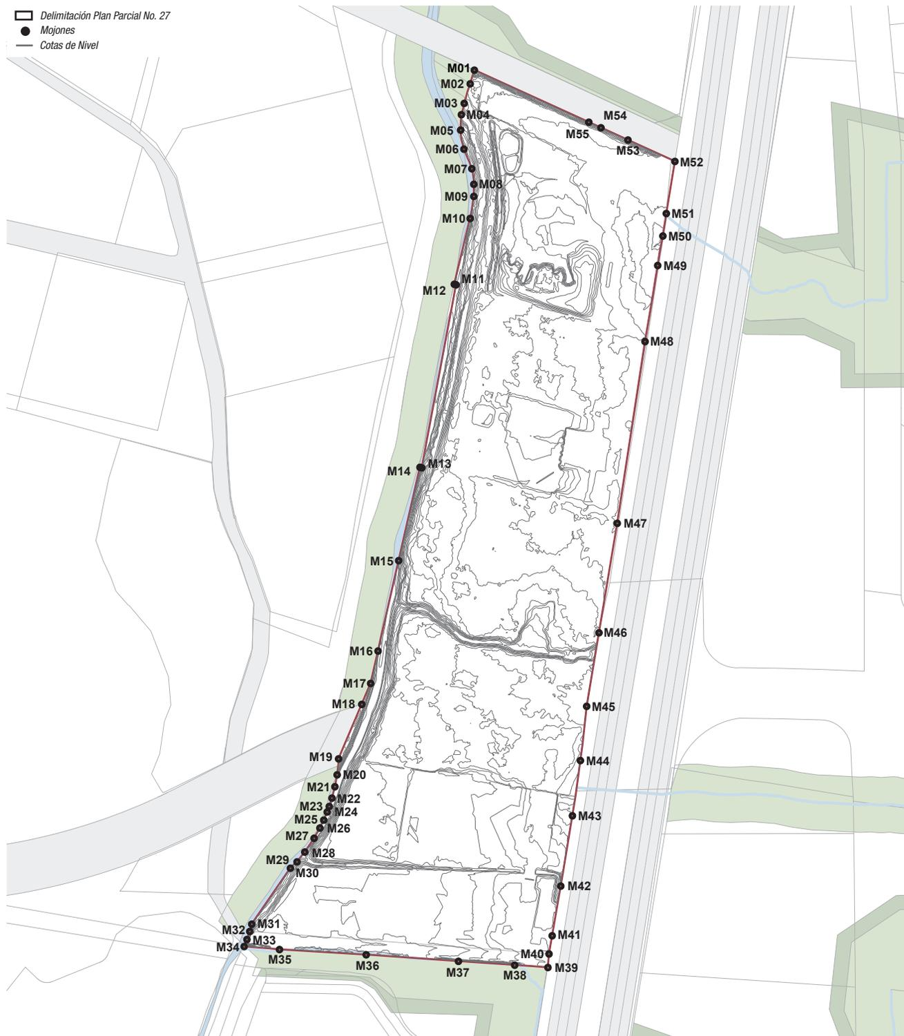
**Figura 31: Levantamiento Topográfico**
