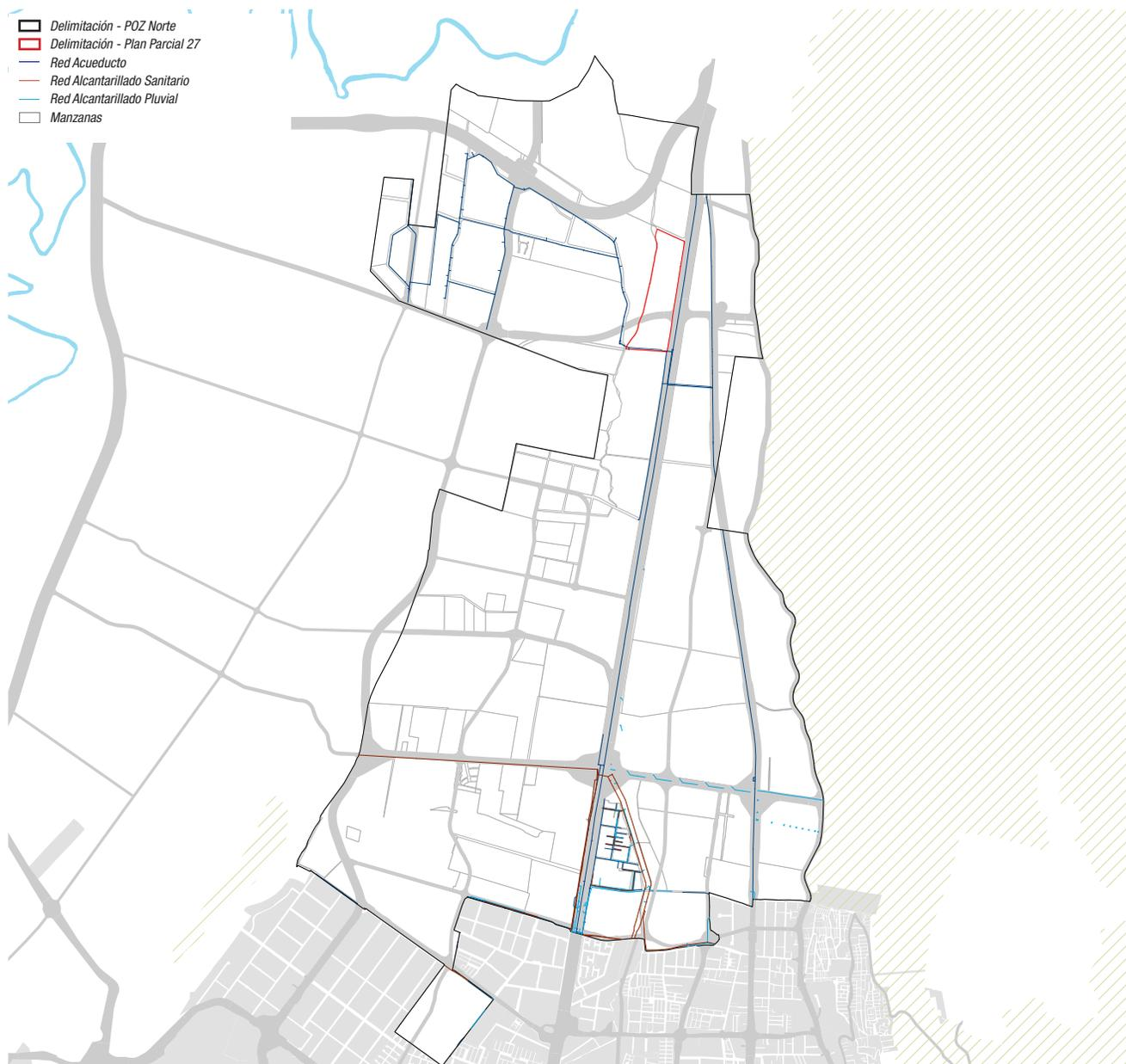
**Figura 11: Red de Acueducto y Alcantarillado Pluvial y Sanitario - POZ Norte**
