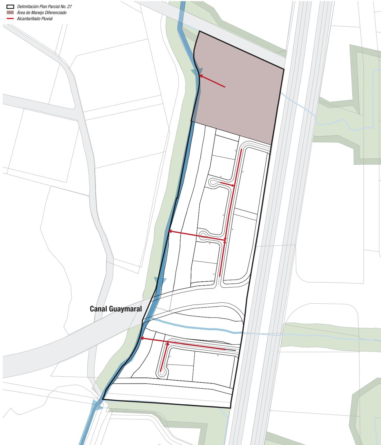
**Figura 60: Sistema de Alcantarillado Pluvial**
