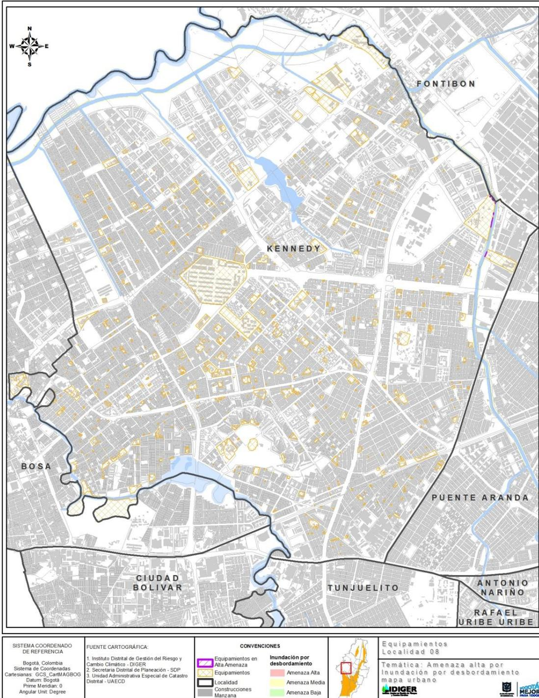
Figura 4.29. Equipamientos en condición de riesgo por inundación por desbordamiento de la localidad de Kennedy
