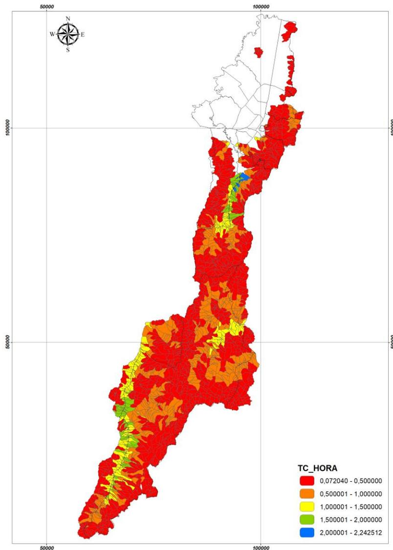
Figura 8.32: Tiempo de concentración (horas) cuencas hidrográficas seleccionadas
