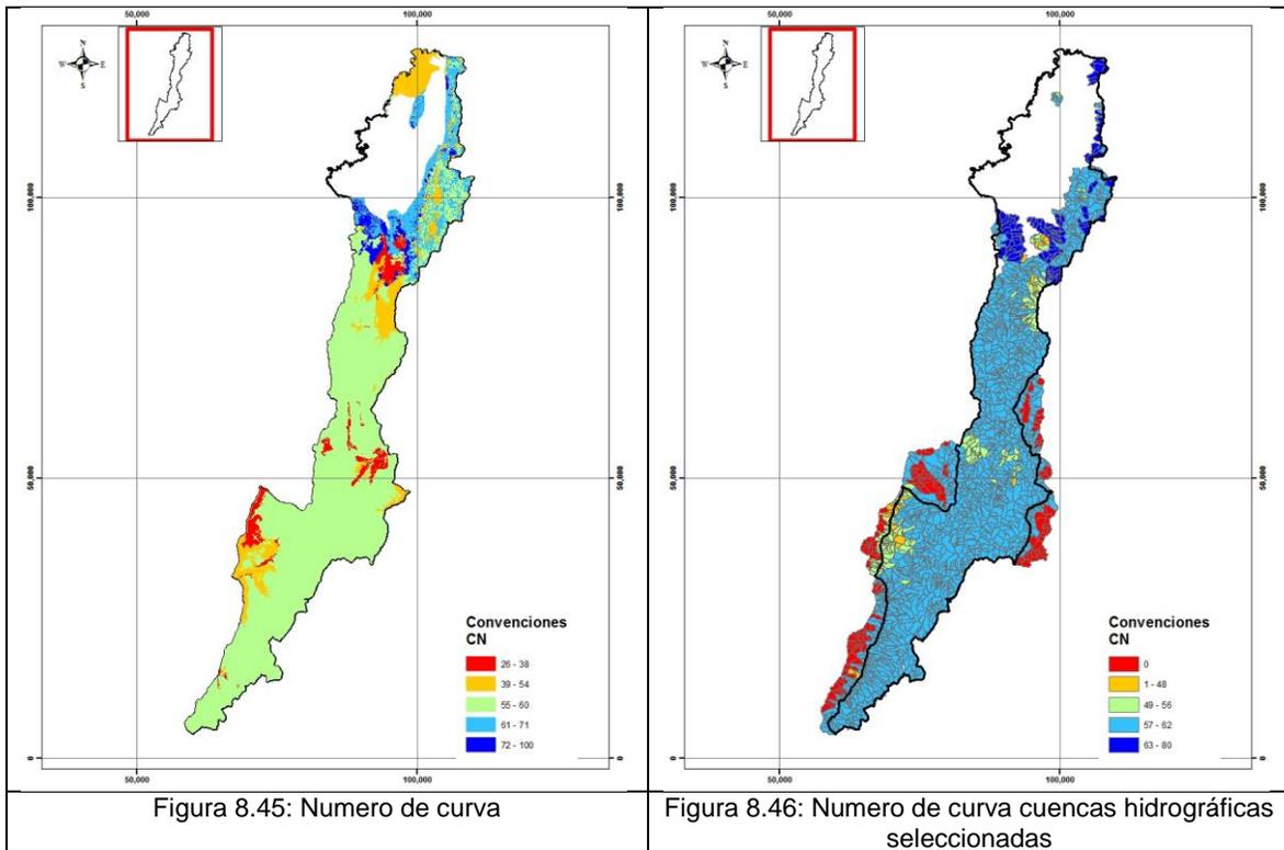
Con el evento de precipitación obtenido a partir de las curvas IDF utilizando el método de bloque alterno y las abstracciones calculadas con el método de número de curva se obtienen los hidrogramas que servirán de entrada al modelo hidráulico. El Caudal Pico de estos hidrogramas se presenta en la Figura 8.47.
