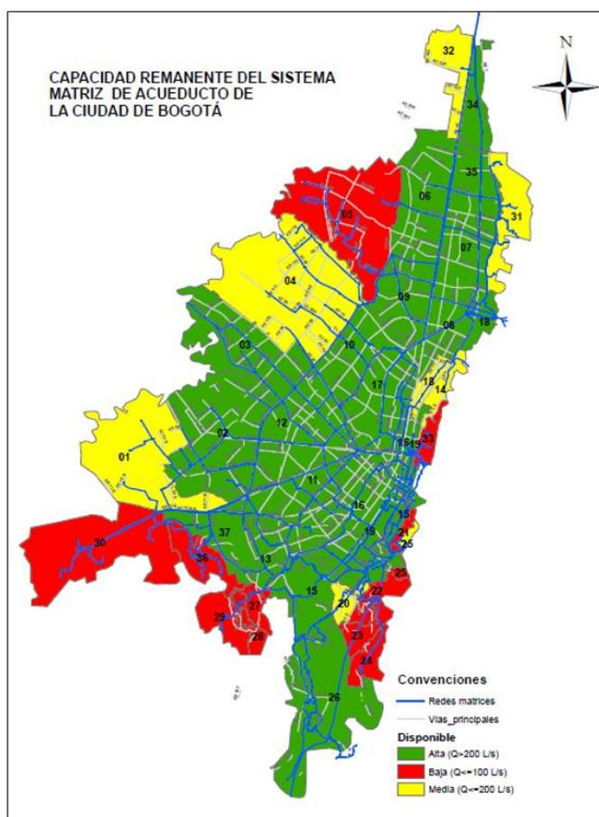
ILUSTRACIÓN 79 - CAPACIDAD REMANENTE DEL SISTEMA MATRIZ DE ACUEDUCTO DE LA CIUDAD DE BOGOTÁ. FUENTE PMMA EAB ESP 2016-2025.
